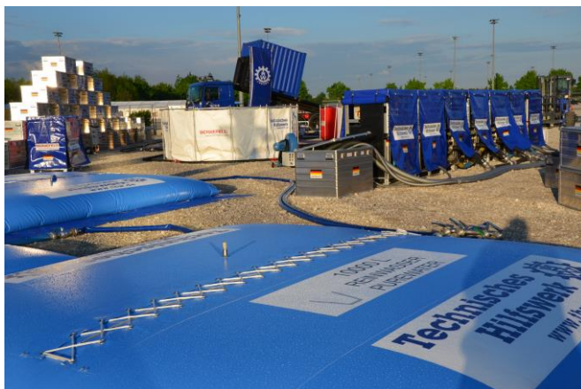
Abbildung 4: Mobile Trinkwasseraufbereitung des THW [6]
