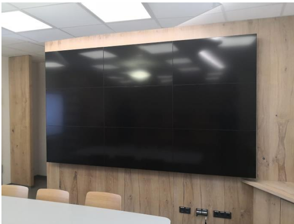
Videowall bestehend aus neun integriertem Fernseher
