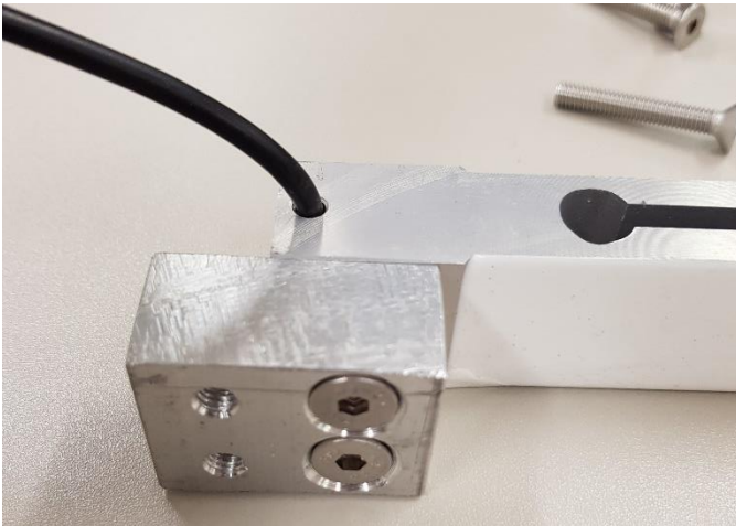
Abbildung 39: Wägezelle mit Distanzstück
