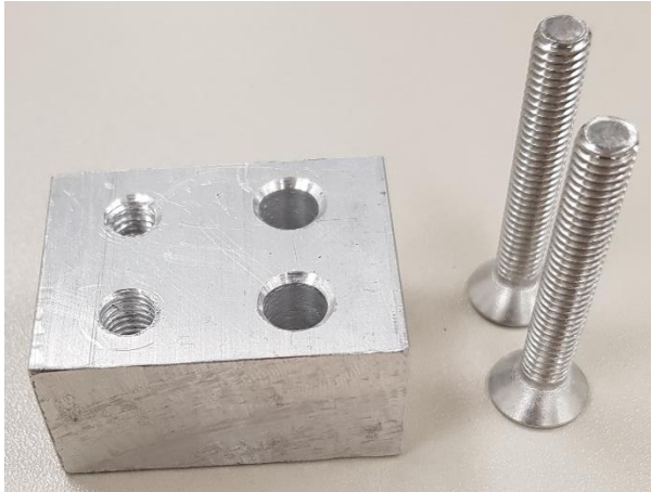
Abbildung 37: Distanzstück und Schrauben
