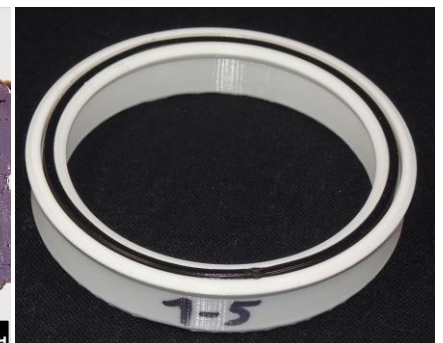
2-Komponenten-Testteil, beide Komponenten additiv gefertigt
